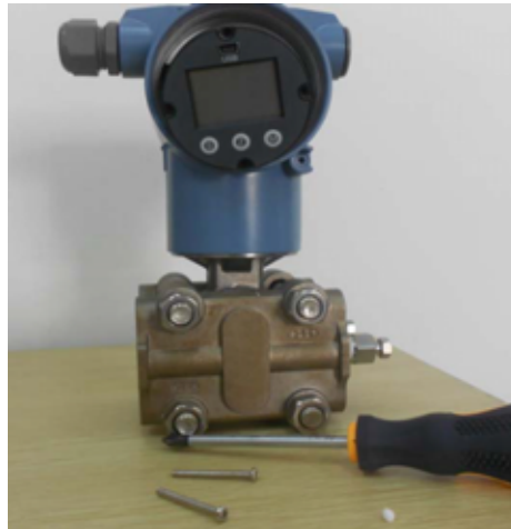
3、用十字螺丝刀拆下两枚紧固螺丝
