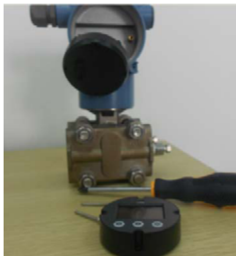
4、表头和控制模块是连接件对接，用手拔出即可
